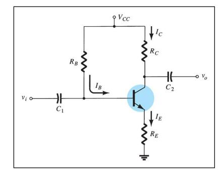
V<sub>CE</sub> = V<sub>CC</sub> − I<sub>C</sub>R<sub>C</sub> − V<sub>E</sub>
